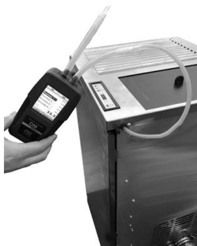
Fig. 27 - Połączenie presostatu cyfrowego
