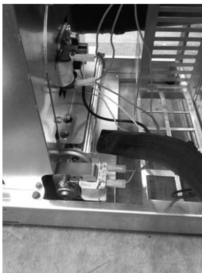
Fig. 35 - Czyszczenie wentylatora
